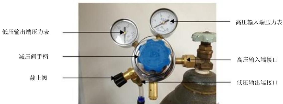
图1 减压阀示意图
