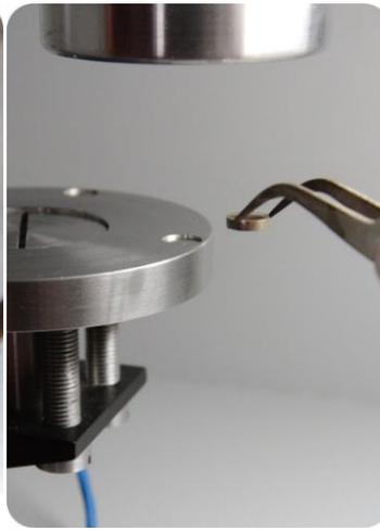
2. 将装有样品载片的培养皿移至 ARTP 诱变育种仪操作室，用无菌镊子将载片放到对应凹槽。
