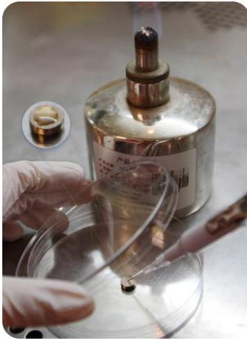
1. 在超净台内，将载片置于酒精灯外焰灼烧30s，待冷却后放到已灭菌培养皿中，取 10uL 菌液均匀涂布在载片表面。
